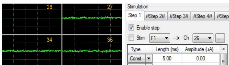
図 1.2.2: 刺激が印加され、信号の取り込みがミュートされた 26ch (左)。 ステミュレーターのチェックを外して“空打ち”を行う (右)。
