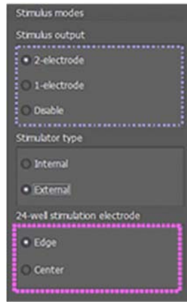
図 3.5. ペーシングの刺激電極数（1 電極または 2 電極）と、刺激電極位置（Edge または Center）の設定。
