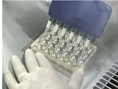
図 2.5. マルチピペットによる培地添加。12 連ピペットに 1 つ飛ばしでマイクロチップを装着。
