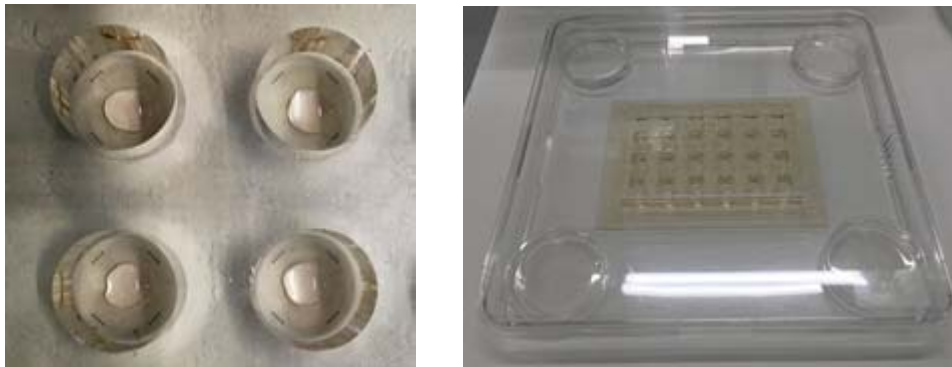
図 2.2. 記録電極上に滴下したフィブロネクチン (左)。MED プレートの保管例 (右)。
