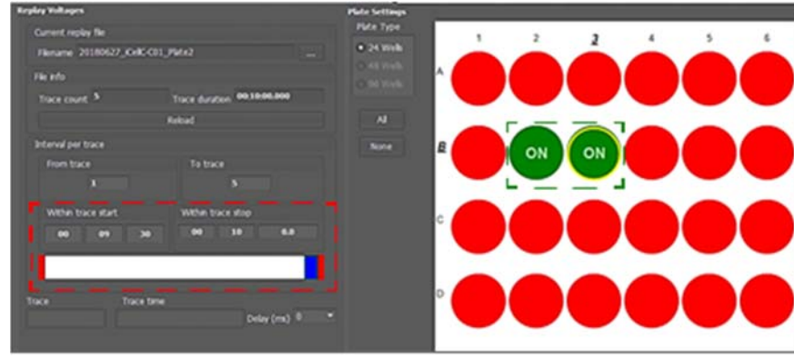
図 3.13. 出力するデータ区間の設定。本例ではウェル B2 及び B3 について、全 5 トレースの各トレース最終 30 s (9m30s-10m00s) のデータを出力する。
