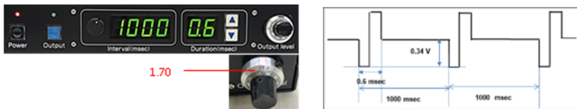
図 3.6. MED ペーシング・コントローラーのフロントパネル（左）の設定と出力刺激パターン（右）の対応。
