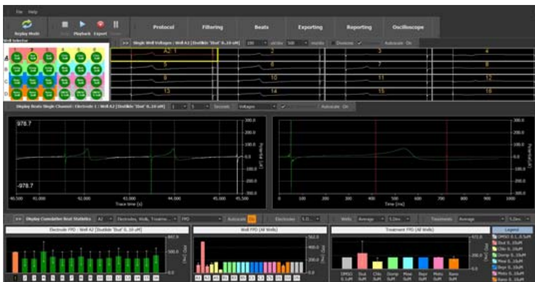
図 3.7. RECORD モードの Cardio ワークフローのメインウィンドウ。 画面上部の Beats をクリックすると Beat Settings ウィンドウが開く。
