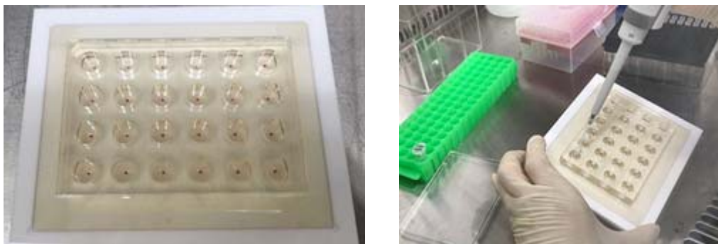
図 2.1. MED スポットコースターの上に 24 ウェル MED プレートを設置。記録電極の位置は赤点でマークされている (左)。赤点を目安にフィブロネクチンを電極上に滴下 (右)。
