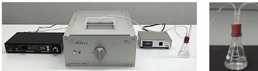
図 3.1. MED64-Presto の実験環境 (左)。高湿度の環境維持のため、ガスは滅菌水を含む三角フラスコ内でバブリングする (右)。
