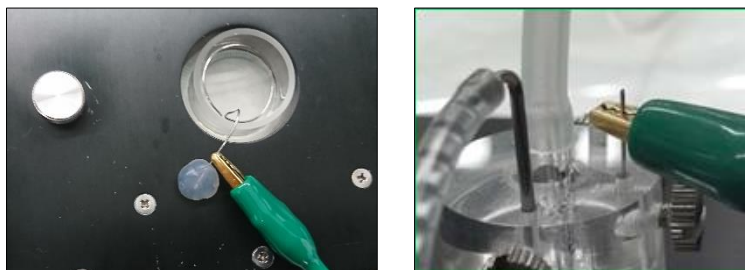
白金線による刺激アーチファクトの低減。MED 灌流キャップ未使用時 (左) と使用時 (右)。
