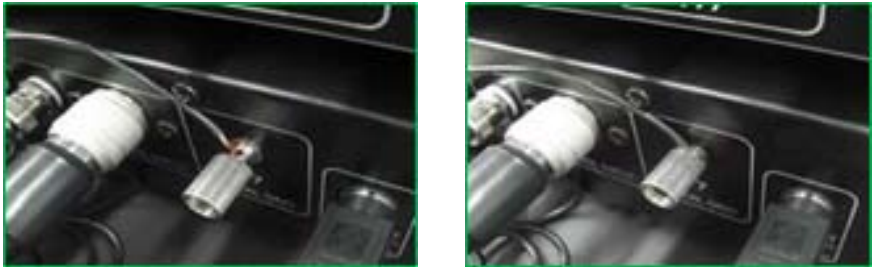
SIGNAL GND 端子のネジを緩めてアース線を孔に通し (左)、ネジを締めて固定する (右)。
