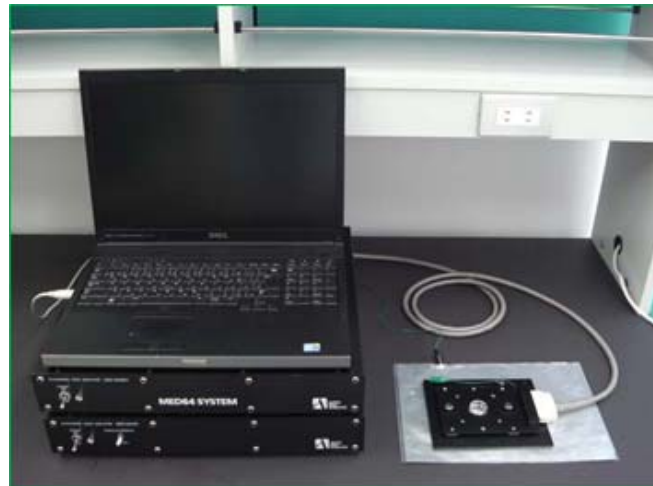
セットアップした MED64-Basic。本例では計測用 PC にノートパソコンを使用。
